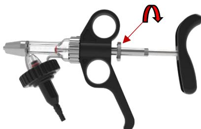
Rändelmutter gegen den Uhrzeigersinn drehen und lösen.
