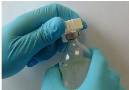
Seleccione el adaptador para la botella correspondiente. Inserte la botella en el adaptador universal
